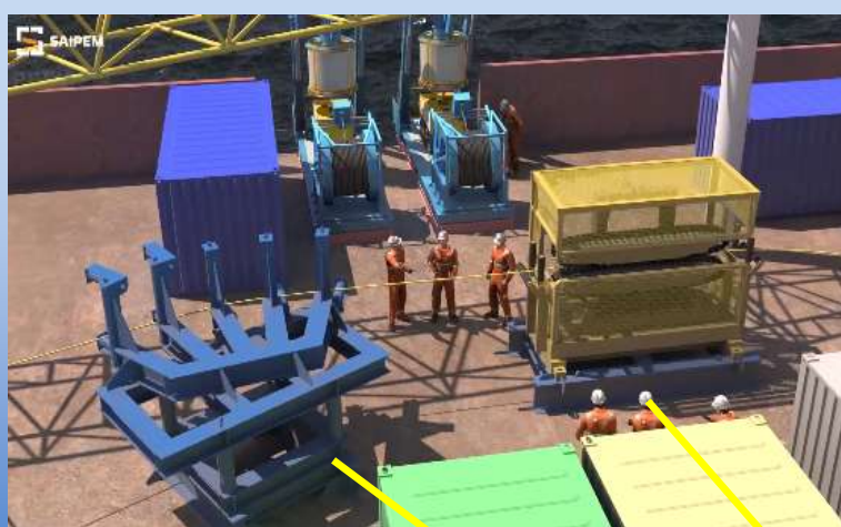
Tensionatore orizzontale: modula il rilascio del cavo, imprime una frenatura controllata. Quadrante di rinvio orizzontale, munito di rulli
