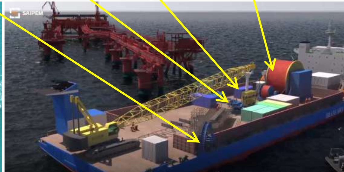
Tensionatore orizzontale: modula il rilascio del cavo, imprime una frenatura controllata. Quadrante di rinvio orizzontale, munito di rulli
