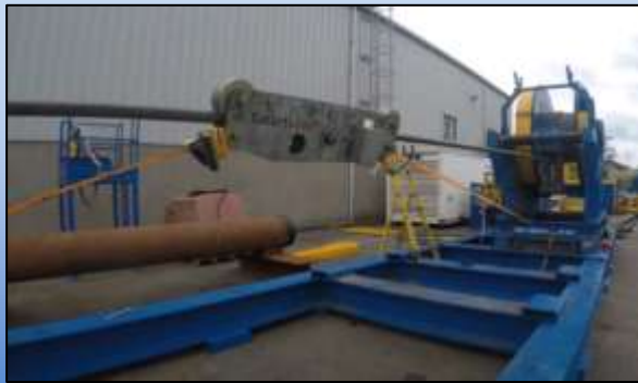
Misura istantanea della tensione nella fune di tiro con Running Line Monitor
