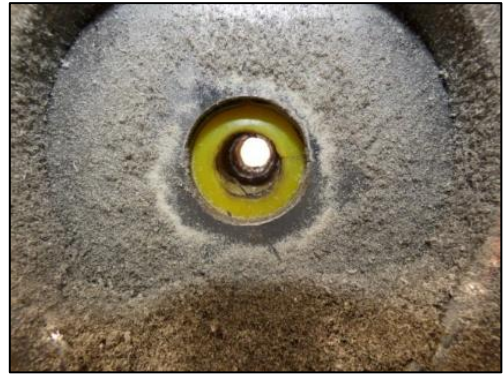
Figure 4.7 / 4.8 – Configurazione finale premistoppa / Usura premistoppa
