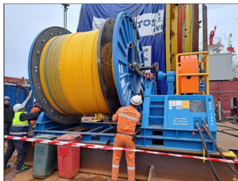
Figure 5.18a, b, c - Tensionatore, Spooling Winch con a bordo la bobina di cavo TLC, Reel hub drive con a bordo la bobina MT
