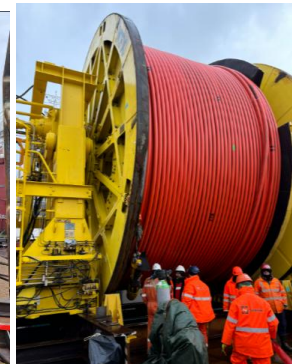
Figure 5.18a, b, c - Tensionatore, Spooling Winch con a bordo la bobina di cavo TLC, Reel hub drive con a bordo la bobina MT
