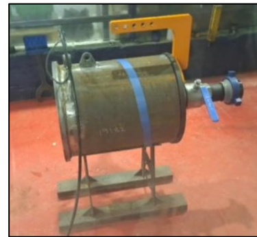
Figure 4.9 / 4.10 – Tappo 22'' prima di essere infilato nel tubo / Tappo 22'' attivato durante prova di tenuta
