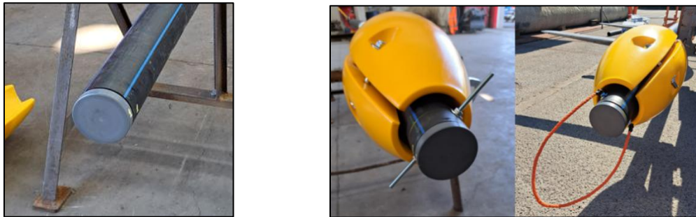
Figure 5.6 / 5.7 - simulacro del cavo MT con e senza boe di alleggerimento per test di attrito
