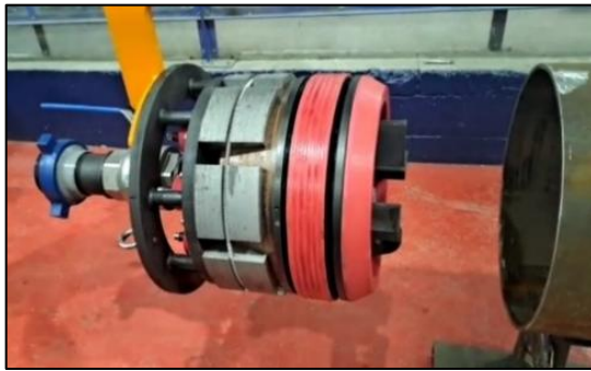
Figure 4.9 / 4.10 – Tappo 22'' prima di essere infilato nel tubo / Tappo 22'' attivato durante prova di tenuta
