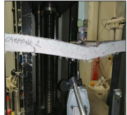
Fotografie di un provino durante e dopo la prova
