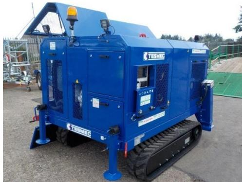
**Figura 2. Argano Tescmec cingolato con configurazione chiusa**
