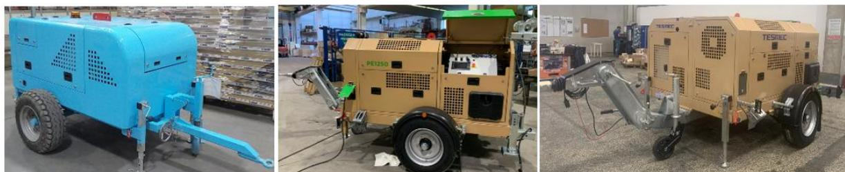
**Figura 4. Da sinistra a destra: PE1150 (30 kN), PE1250 (50 kN), PE1350 (70 kN)**
