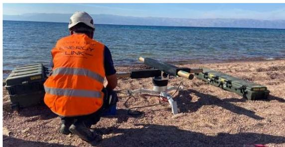
Figura 3 - Sistema PGM Paratrack Gyro Module
